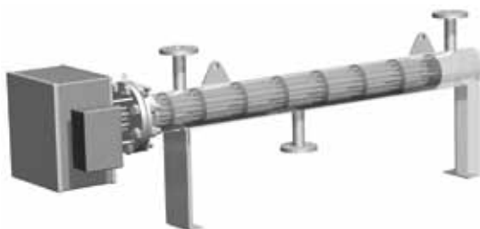
Diseño Ex'e' con baffles tipo varilla de flujo total para una mínima caída de presión
